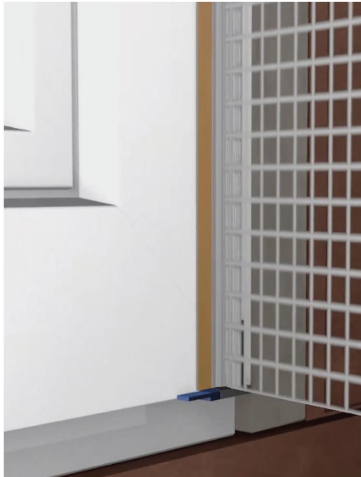
sl. 2: StoProfile Drainage - Pozicioniranje na gips-traci
